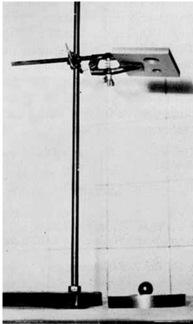
Abb. 12. Versuchsaufbau zur Bestimmung der Bruchsicherheit.
